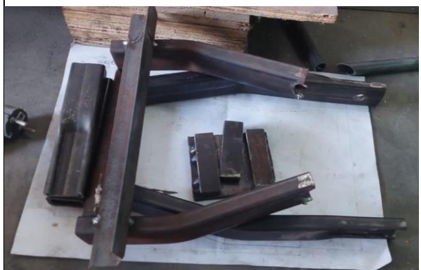
Pemotongan Bahan Material Swing Arm menggunakan Gerinda Duduk
