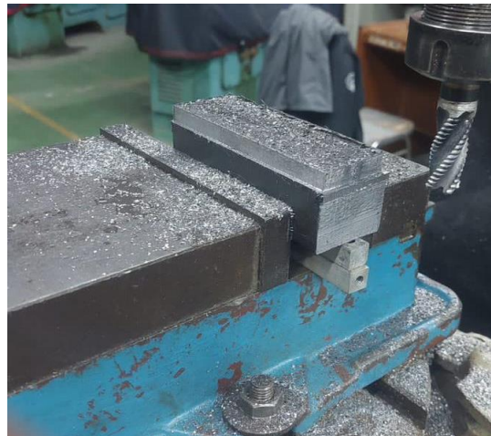
Perautan Bangkon Kaliper Menggunakan Mesin Frise
