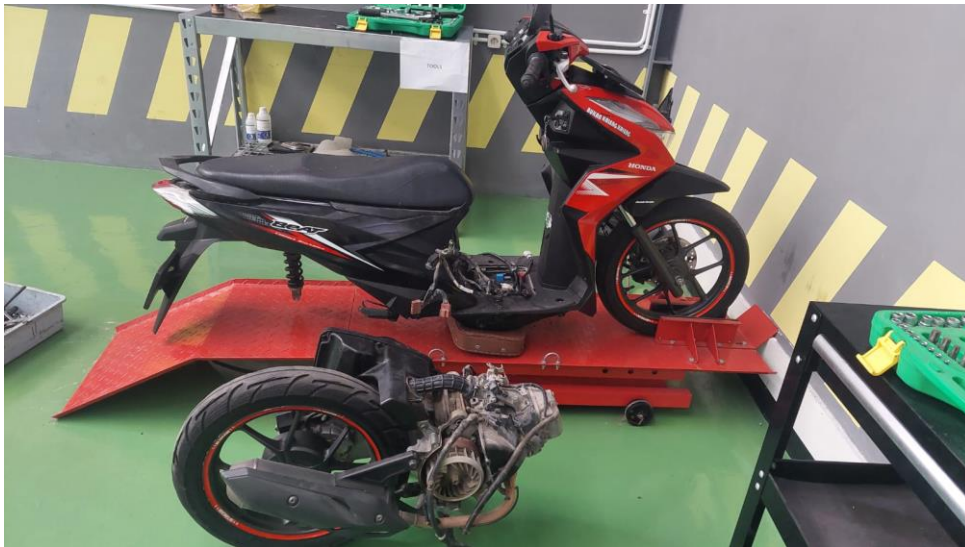
Gambar 4. 6 Pemisahan Engine dengan Chassis
