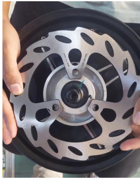
Penyesuain Piringan Untuk Pangkon Kaliper
