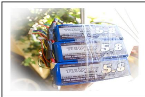
Gambar 4. 3 Baterai LiPo Pack yang dirakit menjadi satu (Sumber : Prasetyo B, 2017)
