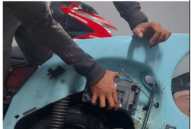
Pemasangan Controlle Vespa
