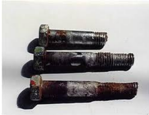
Gambar 2.5 Korosi celah pada baut (Rukawa, 2010)
