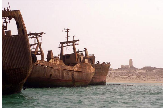
Gambar 2.4 Korosi homogen pada badan kapal (Rahayu, 2010)
