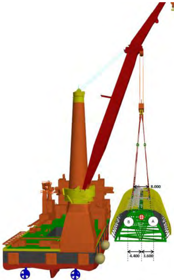
Gambar. 4.13 Konfigurasi rigging Kapal saat mengangkat beban RSS (tampak belakang)
