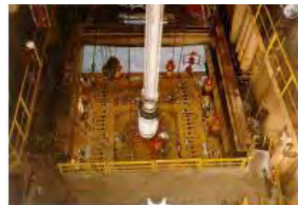
b) menggunakan Drilling Riser
