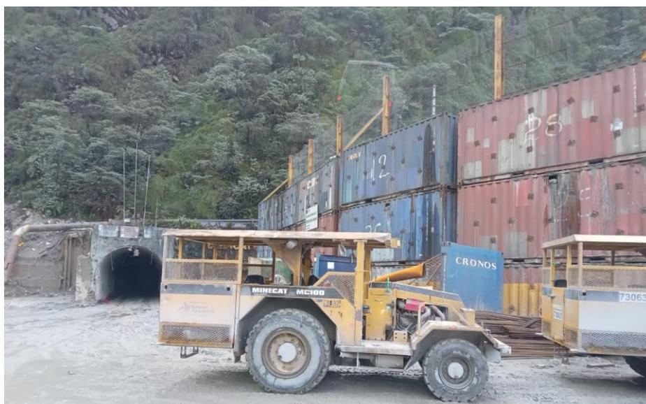
**Gambar 2. 6** Minecat sebagai *Underground Equipment* Keluar dari MLA Portal
