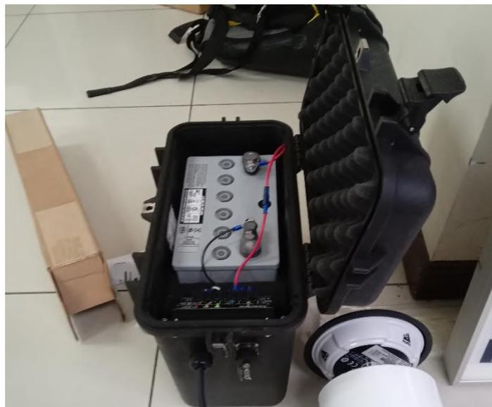
**Gambar 2. 13** Baterai Sebagai *Power Supply* Utama Bagi GPS
