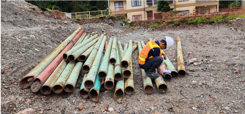
**Gambar 5. 8** *Sampling* Dimensi Material Pipa yang Digunakan di Lapangan
