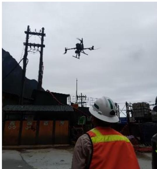
**Gambar 5. 2** Kegiatan *Drone Inspection* dari Amole Batch Plant
