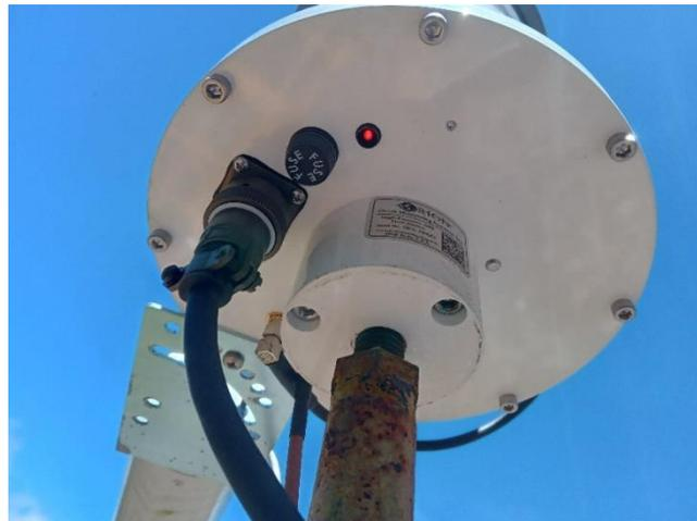
**Gambar 2. 18** Lampu Indikator GPS
