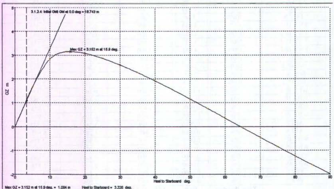
Gambar 4.19. Kurva stabilitas kondisi 1 dengan pengaruh angin.
