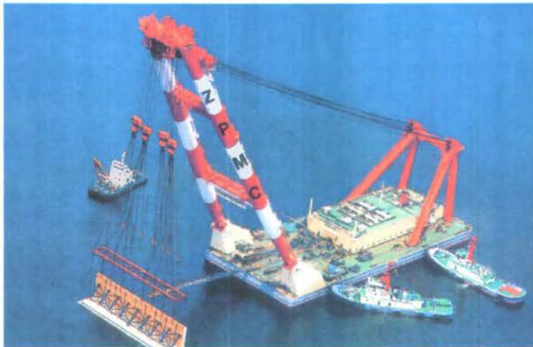
Gambar 2.2. Floating crane tipe fixed crane dengan lengan tak bergerak ( www.jraymcdermott.com , diakses pada tanggal 8 Januari 2007).
