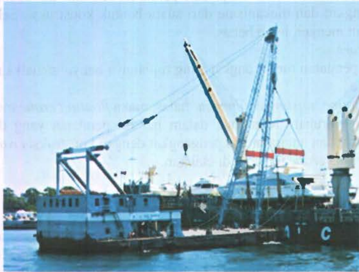
Gambar 2.3. Floating crane tipe fixed crane dengan lengan bergerak ( www.jraymcdermott.com , diakses pada tanggal 8 Januari 2007).
