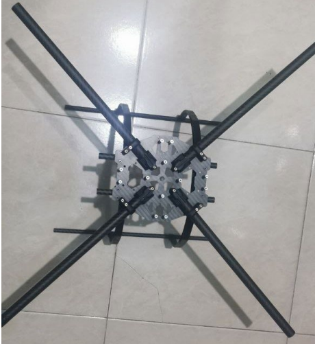
Gambar 3. 15 Frame Tarrot 650mm dan Instalasi Motor pada Frame (Sumber, Penulis)
