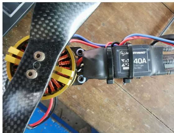
Gambar 3. 16 Instalasi Baling-baling dan ESC (Sumber, Penulis)
