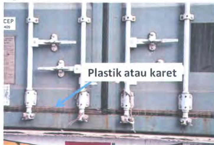
Gambar 2.11. Instalasi karet di pintu peti kemas
