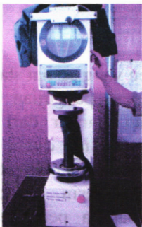
Gambar 3.7 (a) Alat Uji Indentasi; (b) proses pengujian indentasi Brinell
