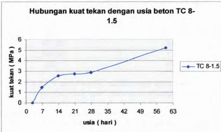
Gambar 4.45 Hubungan kuat tekan dengan usia beton TC 8-1.5
