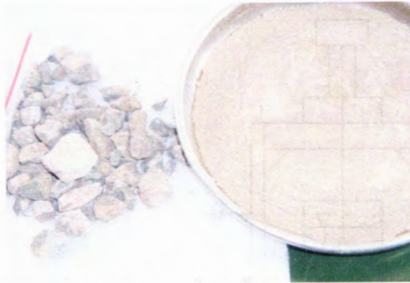
Gambar 3.30 Beton setelah dihaluskan
