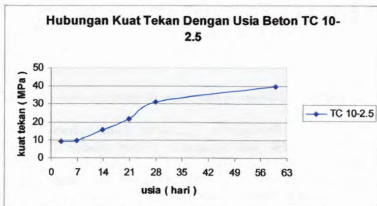
Gambar 4.53 Hubungan kuat tekan dengan usia beton TC 10-2.5
