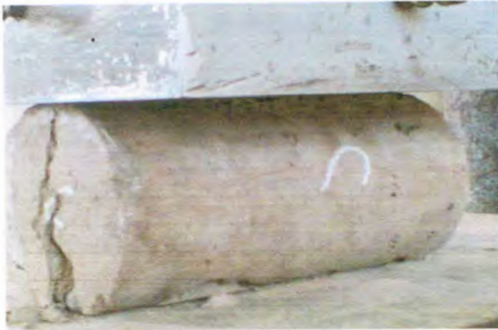
Gambar 3.26 Kondisi putus tarik beton geopolimer
