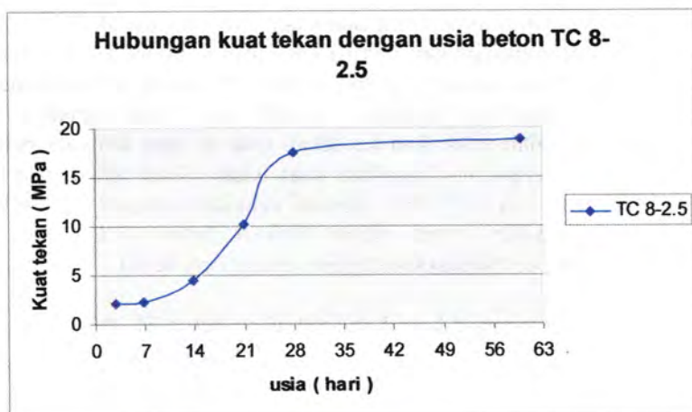
Gambar 4.47 Hubungan kuat tekan dengan usia beton TC 8-2.5
