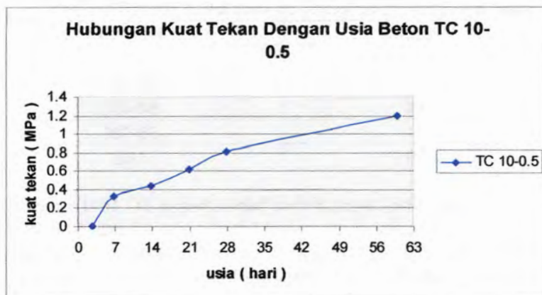
Gambar 4.49 Hubungan kuat tekan dengan usia beton TC 10-0.5
