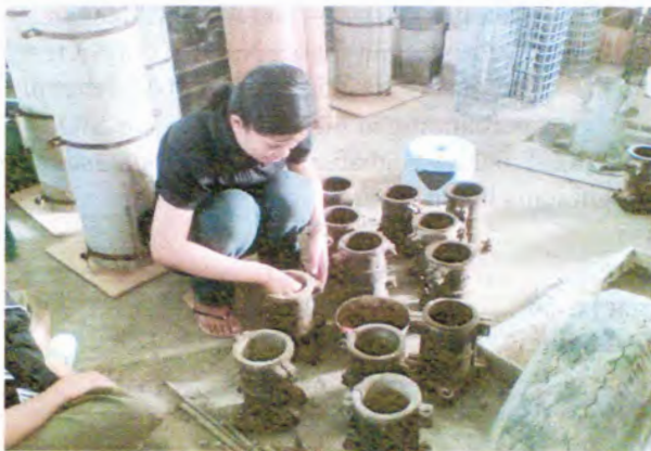
Gambar 3.18 Pelumuran oli pada cetakan beton
