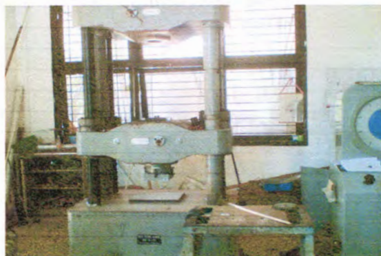
Gambar 3.23 Alat tes tekan beton
