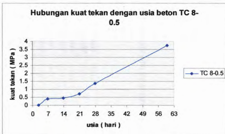
Gambar 4.43 Hubungan kuat tekan dengan usia beton TC 8-0.5
