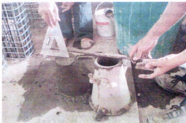
Gambar 4.75 tes slump beton TCC
