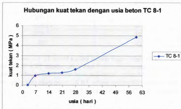
Gambar 4.44 Hubungan kuat tekan dengan usia beton TC 8-1
