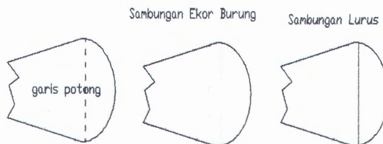
Gambar 4.2 : Jenis Sambungan Pada Daun Balig-Baling
