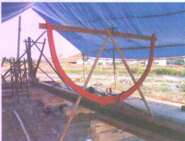
Gambar II.4. Penampang melintang kapal kayu dan proses pembuatannya.
