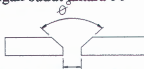
Gambar 2.7 Sudut yang \theta digunakan untuk bevel
