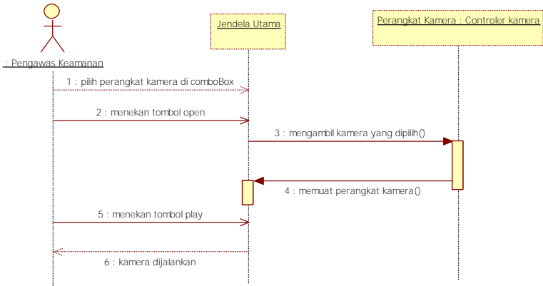
Gambar 3.8 Diagram Urut Kode UC-D03
