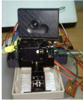
Gambar 4.31 Sistem deteksi wajah yang dibangun dengan arduino Mega 2560, serial kamera ov7670 *without FIFO*, dan servo S3003
