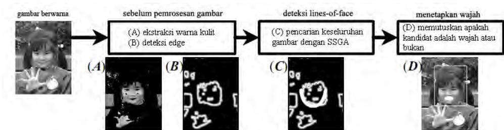
Gambar 2.3 Tiga Tahap Deteksi Wajah dengan Menggunakan *Positive-Negative Lines-of-Face Template* (Hori dkk., 2004)
