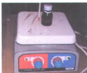
Gambar 3.4 Proses pengadukan larutan Toluena dan serbuk Polystyrene dengan Magnetic Stirrer
