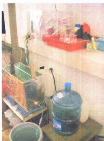
Foto 3. Reaktor Fotokimia Sumber Lampu UV Sistem Kontinyu
