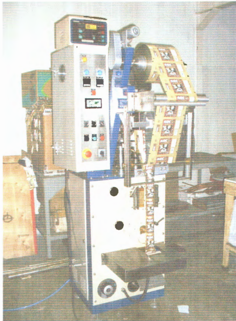
Gambar 4.30. Foto mesin packaging untuk bubuk kopi hasil pengembangan desain.
