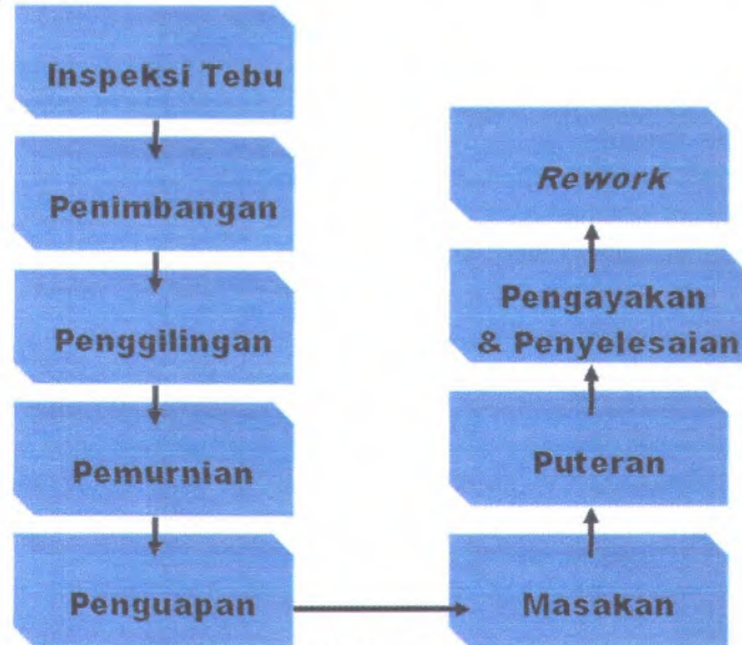
Gambar 4.1 Proses produksi gula kristal putih
