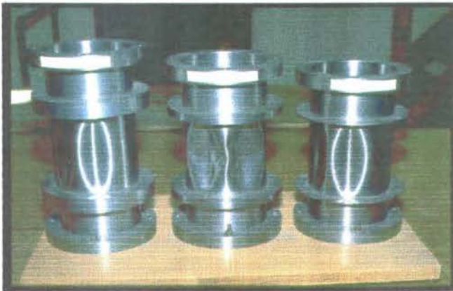
Gambar 2.1 Shell instability pada silinder.
