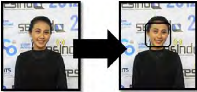
Gambar 2.9 Ilustrasi Hasil Pemrosesan JJIL untuk Kasus Face Detection (kiri=input; kanan=output) (Sumber: dokumentasi penulis)
