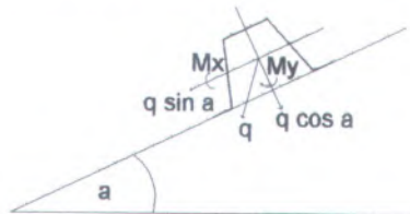
Gambar 4.84 : Arah gaya yang bekerja pada gording
