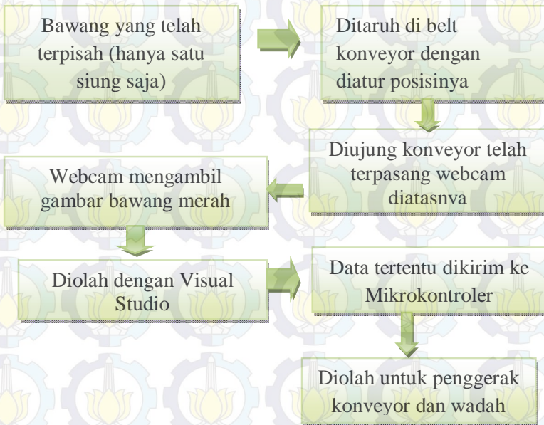
Gambar 4.1. Blok diagram prinsip dasar pemilah bawang merah
