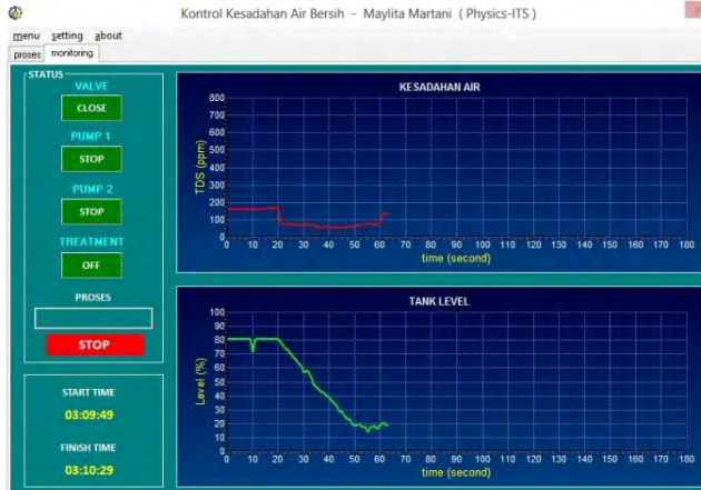
Gambar 4.9 Pengukuran level tangki pada proses storage
