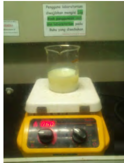
Proses Pencampuran Larutan \text{FeCl}_3 \cdot 6\text{H}_2\text{O} dan (\text{NH}_4)_2\text{HPO}_4
