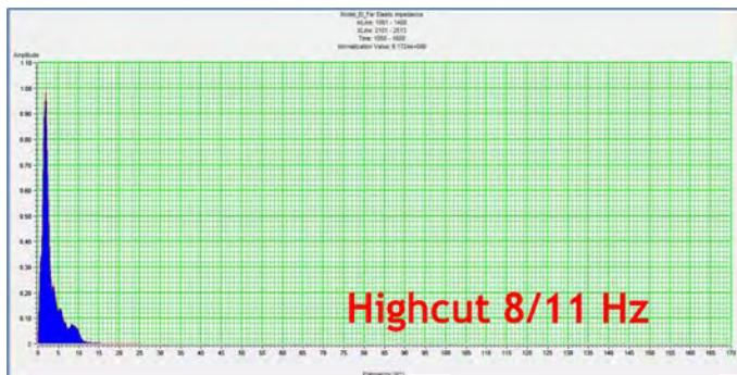
Gambar 4.22. Spektrum frekuensi model untuk inversi far angle
