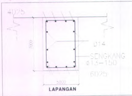
Gambar 4.29. Penulangan Lapangan pada balok
