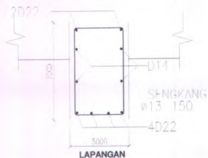
Gambar 2.32. Penulangan balok memanjang pada lapangan
