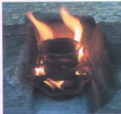
Gambar IV.3.2 Uji memanaskan air 100 ml dengan biobriket dari *bottom ash* dan limbah karbon aktif
