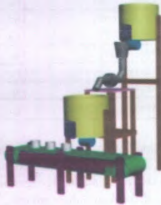
Gambar 4.2 Gambar 3D Otomasi Pengolahan dan Pewadahan Kedelai Matang
