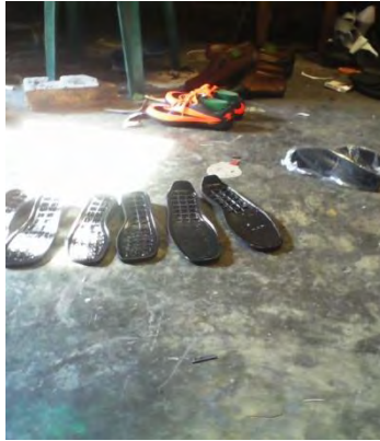
Gambar 2.1 Proses Pengeringan Lem Pada Sol
