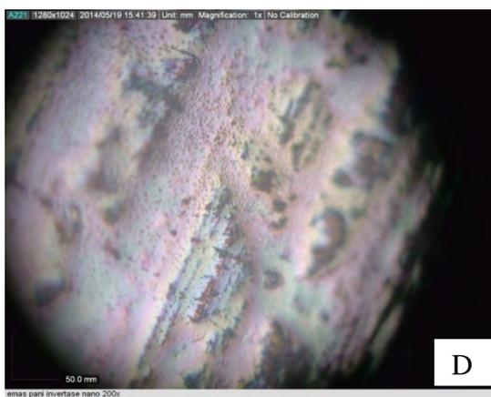
Gambar 4.2 Korosi *Pitting Tin plate* dengan Variasi Waktu Elektroforesis (c) 30 menit; (d) 40 menit
