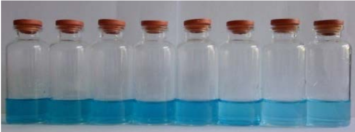
Gambar 4.9 Perubahan warna malachite green sebelum dan sesudah degradasi setelah pengenceran 10 kali
