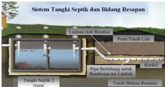
Gambar 2.10 Sistem Tangki Septik (Purwanti, 2003).
