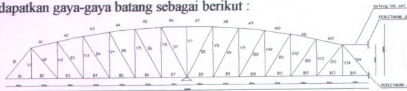
Gambar 7.1.2 sketsa rangka utama bentang 80 m saat peluncuran
