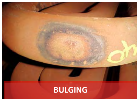
Gambar 2.4 Bulging pada U-Bend Section [13]
