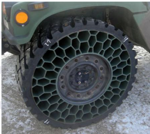
Gambar 2.2. Contoh penerapan ban tanpa udara pada kendaraan militer Amerika [2]
