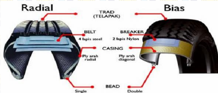
Gambar 2.3 Struktur ban radial dan ban bias [3]
