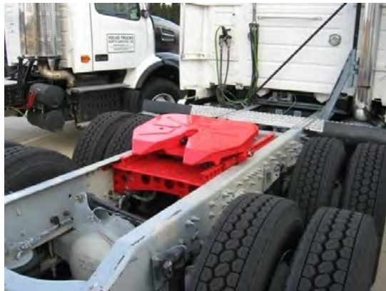
Gambar 2.3 Fifth wheel hitch pada truk trailer
