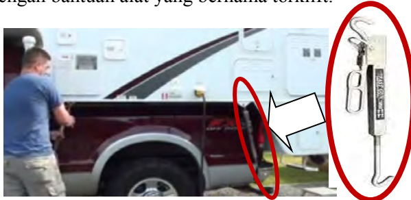
Gambar 2.6 Pengunci box karavan dengan menggunakan torlift.
