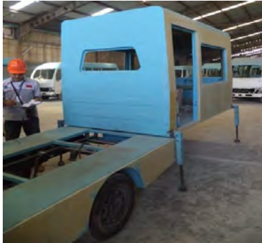
Gambar 1.1 Mekanisme peletakan box pada chasis pickup mobil multiguna
