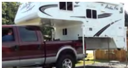
Gambar 2.5 pemasangan box karavan dengan pickup
