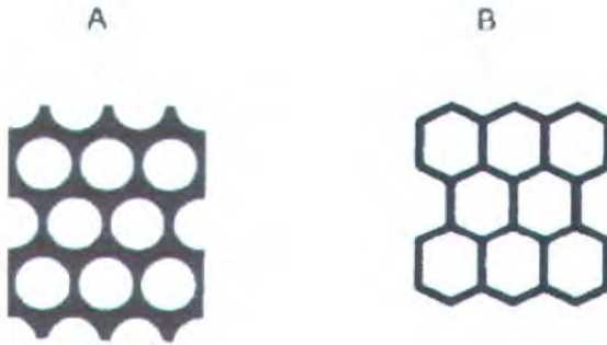
Gambar 2.3 Struktur MCM-41 dengan pori silindris (A) (Feuston et al. , 1994) dan pori heksagonal (B) (Behrens dan Stucky, 1993)
