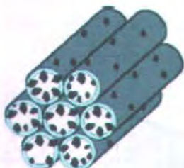
Gambar 2.2 Struktur tiga dimensi MCM-41 (Yang, 2009)
