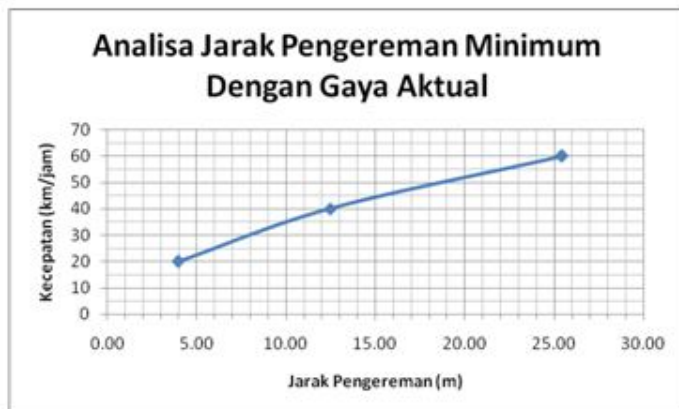
Gambar 4.5. Grafik jarak pengereman minimum vs kecepatan (gaya rem aktual)
