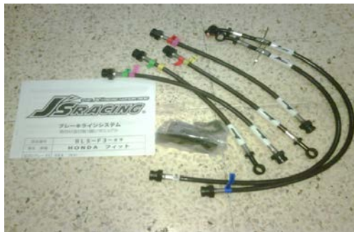
Gambar 2.5. Gambar saluran pengereman
