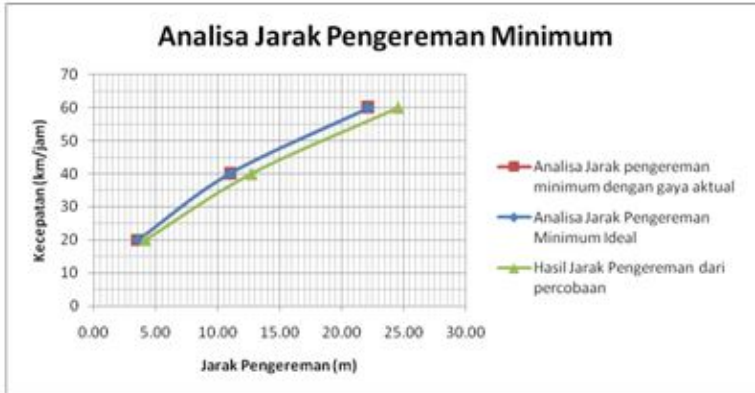
Gambar 4.7. Grafik jarak pengereman minimum vs kecepatan (pengereman minimum ideal, gaya rem aktual dan hasil percobaan)
