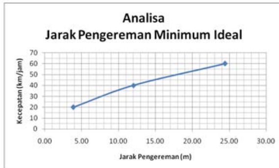
Gambar 4.4. Grafik jarak pengereman minimum vs kecepatan
