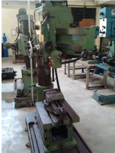
Gambar 3.2. Mesin gurdi radial KMR-700 DS
