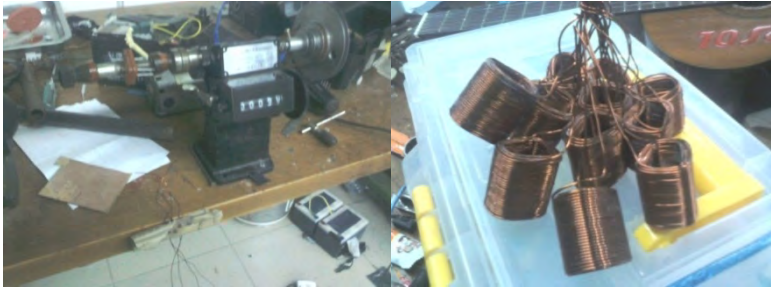
Gambar 4.7 Alat Untuk Menggulung Kumaran dan Kumaran Tanpa Armature (Coreless)
