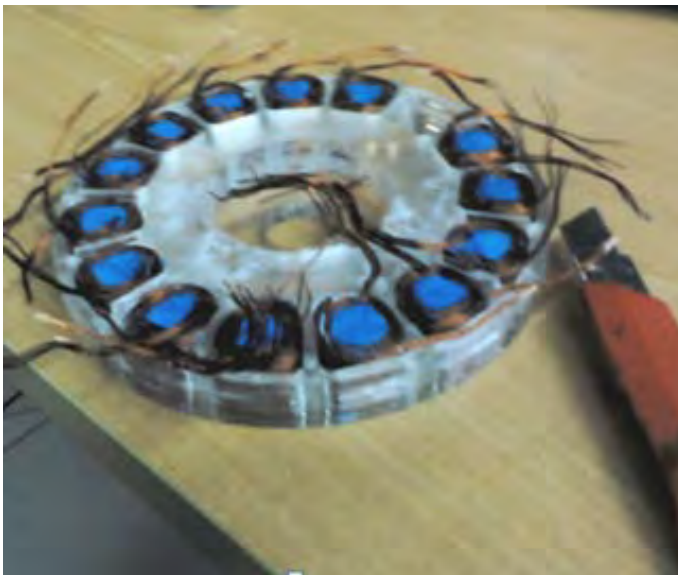
Gambar 4.8 Stator Axial Coreless Brushless DC Motor dan Kumaran Pada gambar 4.8 ditunjukkan hasil pemasangan kumaran pada stator yang diakhiri dengan penggunaan epoxy resin untuk menempelkan kumaran secara permanen pada stator nampak.
