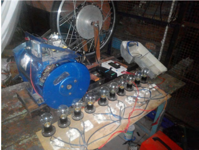
Gambar 5.5 Axial Flux Coreless Brushless DC Motor yang dikoppel pada generator
