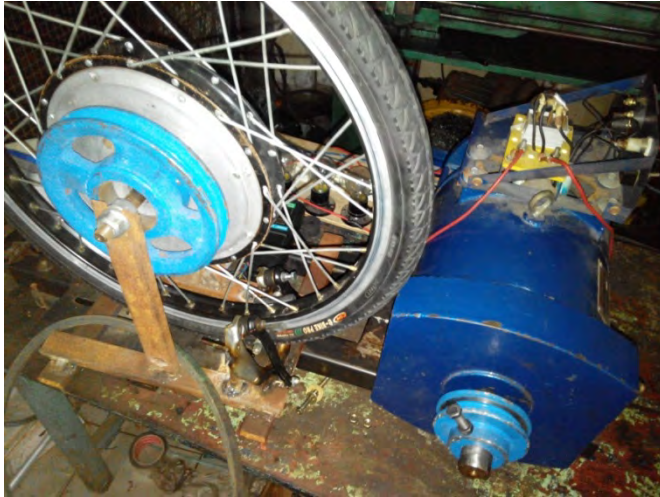
Gambar 5.4 Axial Flux Coreless Brushless DC Motor dengan pengujian breaking
