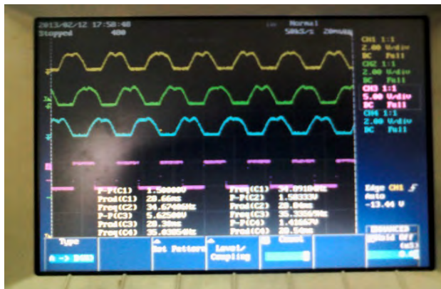
Gambar 3.5 Hasil pembacaan signal sensor hall posisi terhadap komutasi fase U, V, & W
