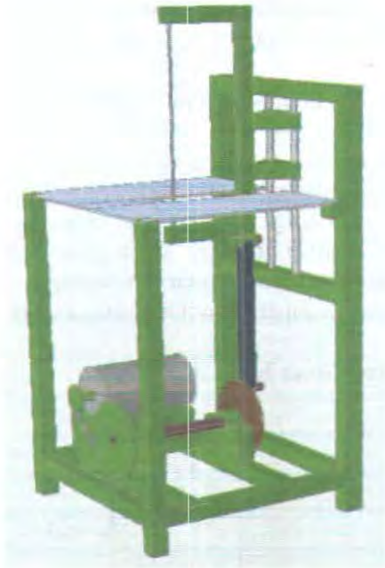
Gambar 2.1. Mesin Gergaji kayu dengan mata gergaji vertikal
