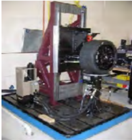
Gambar 2.8 Quarter Car Suspension Test Rig dengan servo hydraulic acuator (sumber : justin D. Langdon thesis)
