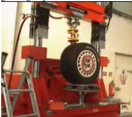
Gambar 2.5 quarter car test rig yang dikembangkan ServoTest (Sumber : Justin D. Langdon's thesis)
