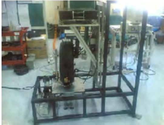
Gambar 2.7 Quarter Car Suspension Test Rig yang dikembangkan oleh Universitas Teknologi Malaysia (sumber : Research Management Centre Universiti Teknologi Malaysia)
