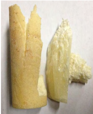
Gambar 4.6 Komposit variasi fraksi volume 16% HGM dengan temperature curing 27°C selama 24 jam.
