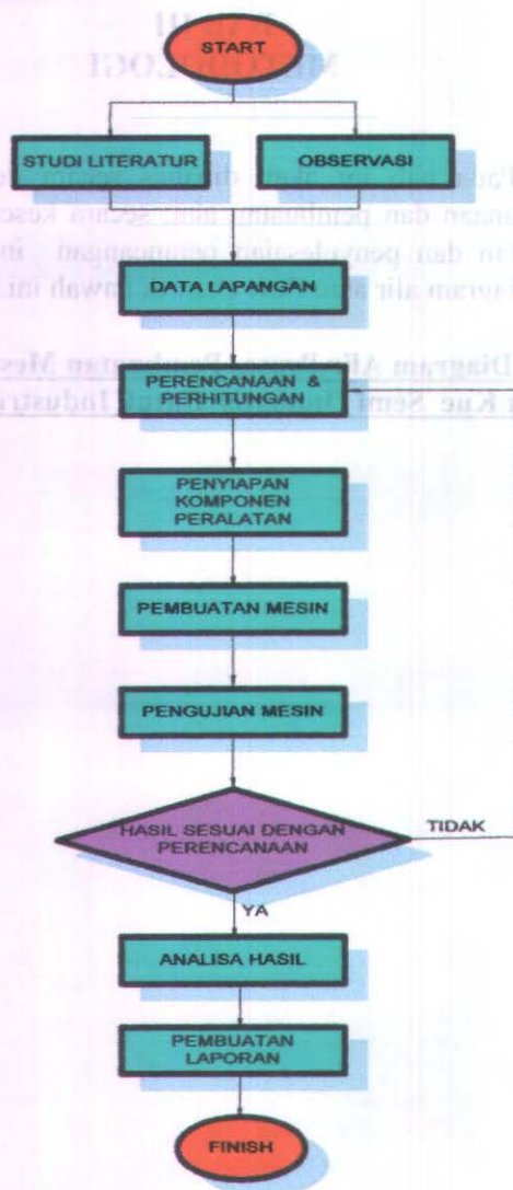
Gambar 3.1 Diagram Alir Pembuatan Mesin Mixer Adonan Kue Semi Otomatis Untuk Industri Kecil
