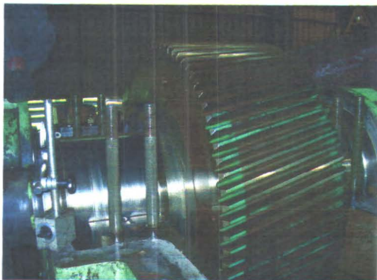
Gambar Pembongkaran Gear Box Waktu Over Houl
