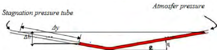
Gambar 3.7 Pembacaan wall pressure tap pada inclined manometer
