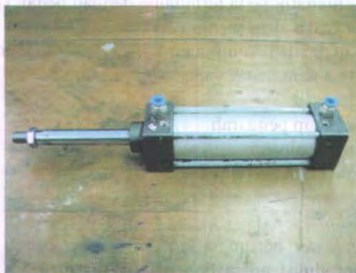
Gambar 2.8 Air cylinder yang berfungsi seperti kompresor
