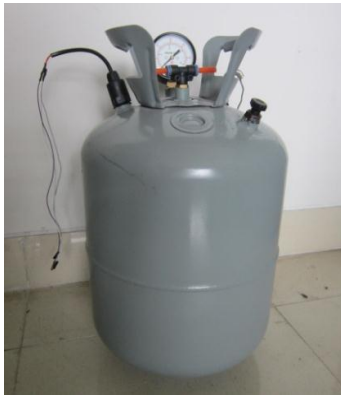
Gambar 1. Tabung kalibrasi yang telah terpasang pressure gauge , pressure transmitter , three-way valve , sensor oksigen, termokopel, dan katup pembuangan.
