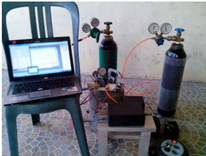
Gambar 4.13. Koneksi komponen elektrik dan non-elektrik
