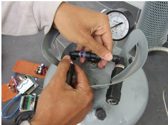
Gambar 6.6 Proses penyambungan three-way valve dengan one-way valve .
