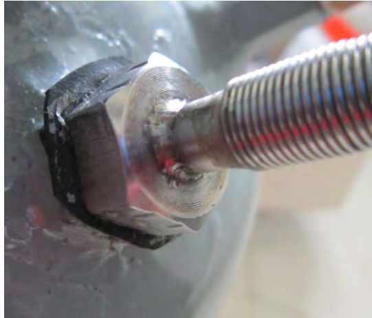
Gambar 4.7 Pemasangan termokopel pada tabung kalibrasi.
