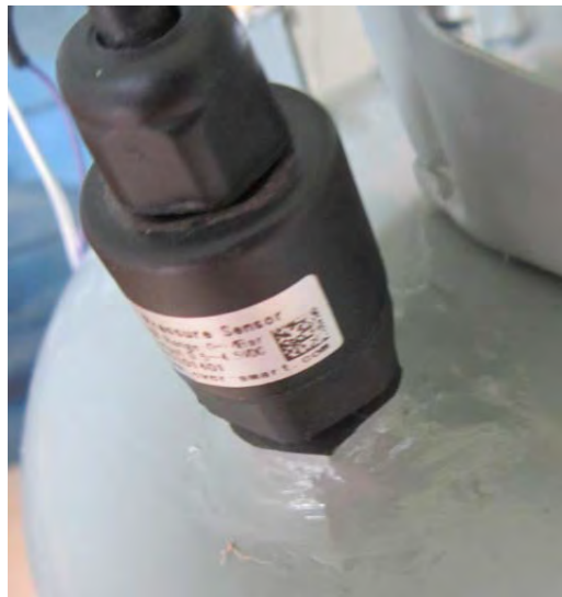
Gambar 4.6 Pemasangan sensor tekanan pada tabung kalibrasi.
