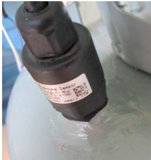
Gambar 4.6 Pemasangan sensor tekanan pada tabung kalibrasi.
