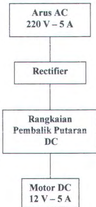
Gambar 4.6 Blok Diagram Rangkaian Listrik Pada Mesin Pembelah Durian
