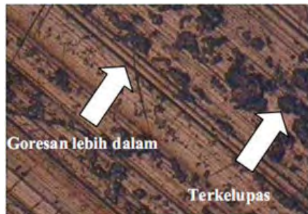
Gambar 2.2 Hasil Penelitian Susastro Untuk Pengujian Dry Sliding Dan Wet Sliding
